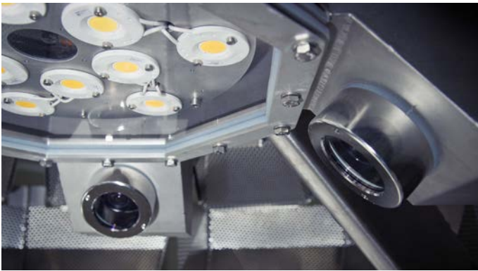
■ Abb. 2: Kameraobjektive nehmen Produktströme unter Hochgeschwindigkeitsbedingungen ins Visier – der Multicheck ist ein optisches System, entwickelt zur Inspektion von Produkten in Mehrkopfwaagen.
